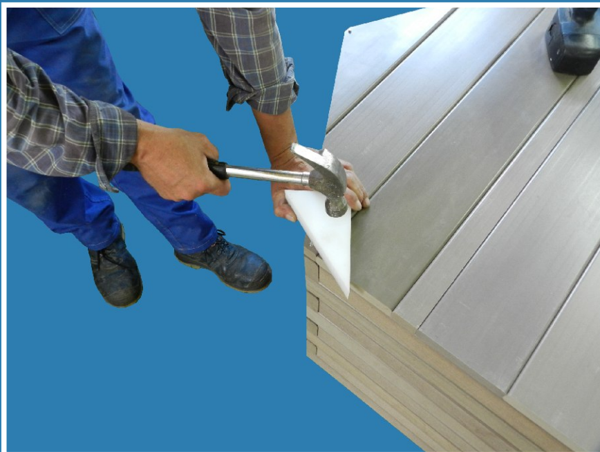
14 Montaż dna donicy etap 2: należy dobić narożniki młotkiem używając przekładki np. deski
