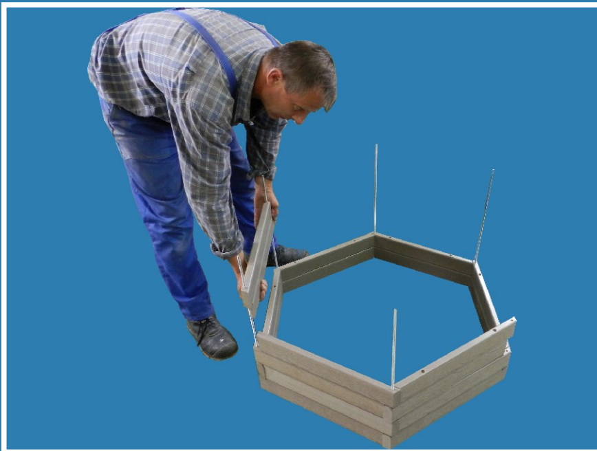
07 Składanie ścian donicy etap 4
