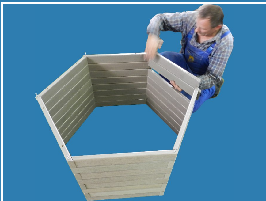
08 Składanie ścian donicy etap 5
